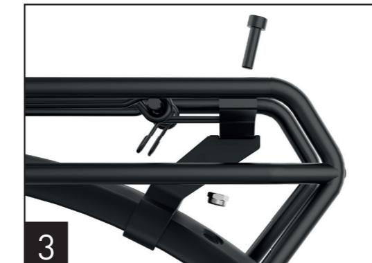
3. Verschrauben Sie den Schiebebrücken-Adapter mit dem hinteren Ende des Gepäckträgers. Verwenden Sie hierzu die mitgelieferte M6x22mm Inbusschraube und M6 Mutter.
