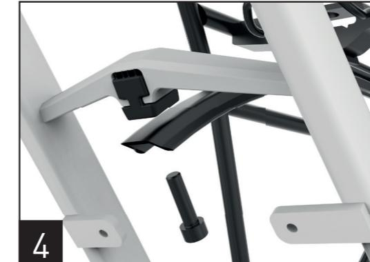
4. Setzen Sie die Träger-Einheit auf den Fahrradrahmen und verschrauben Sie das Langloch der Unterlaufstrebe mit der Sitzstrebengelenkbrücke des Rahmens. Verwenden Sie hier die M6x22mm Inbusschraube.
