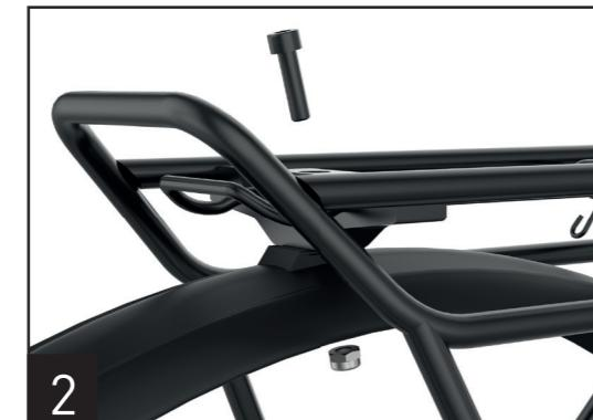
2. Verbinden Sie das vordere Ende des Gepäckträgers mit dem Schutzblech und der Unterlaufstrebe. Verwenden Sie hierzu den mitgelieferten Adapter (siehe Übersicht!), die M6x22mm Inbusschraube und M6 Mutter.
