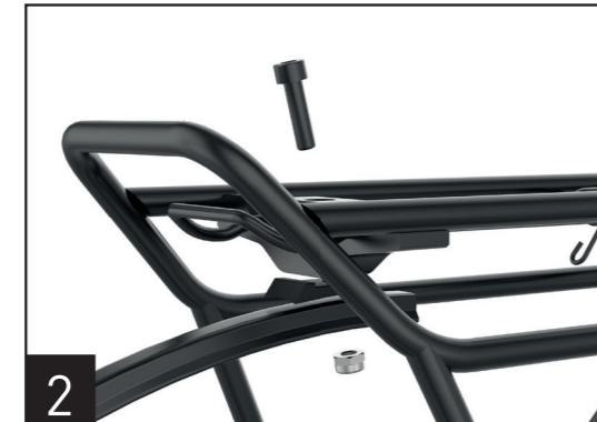
2. Verschrauben Sie den vorderen Montagepunkt des Gepäckträgers mit der Unterlaufstrebe am von Ihnen markierten Montagepunkt mit dem mitgelieferten Adapter (zwischen Träger und Unterlaufstrebe), der M6x22mm Inbusschraube und M6 Mutter.
