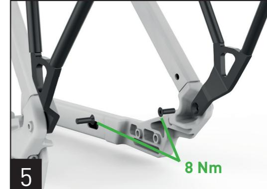
5. Verschrauben Sie anschließend die Ausfallenden des Trägers mit den SIC-Schnittstellen des Rahmens. Verwenden Sie dazu die mitgelieferten M5x12mm Senkkopfschrauben.
