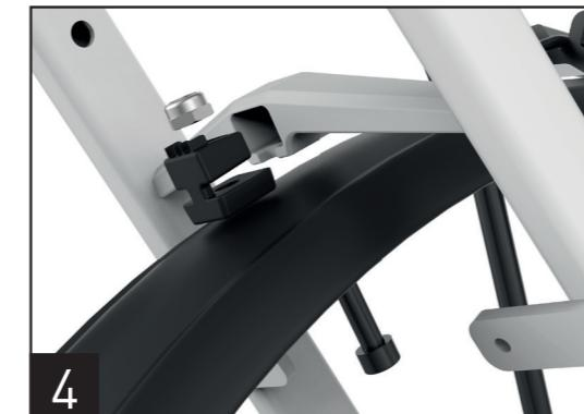
Klicken Sie anschließend den Schiebebrücken-Adapter auf das Schutzblech.
