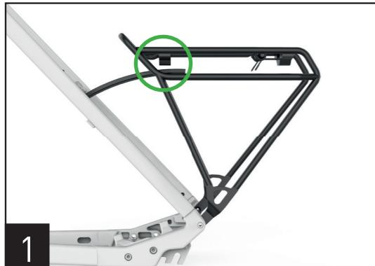
1. Setzen Sie den Gepäckträger mit dem Ausfallende in die SIC-Schnittstelle des Rahmens und achten Sie auf eine horizontale Ausrichtung des Trägers. Markieren Sie sich den Montage-Punkt an der Unterlaufstrebe mit einem Stift oder einem Stück Klebeband.
