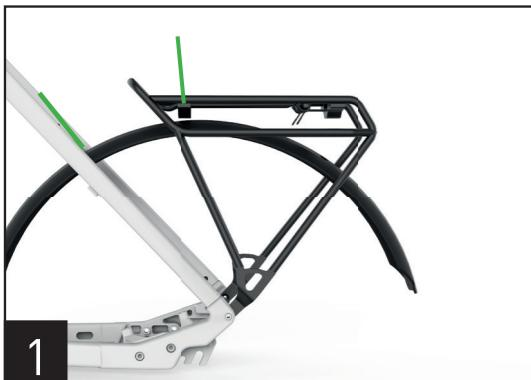
1. Setzen Sie den Träger in die SIC-Schnittstelle des Rahmens. Achten Sie auf eine horizontale Ausrichtung des Trägers und markieren Sie sich die beiden Montage-Punkte des Gepäckträgers mit einem Stift am Schutzblech. Bohren Sie mit einem 7mm Bohrer anschließend mittig an den von Ihnen markierten Punkten durch das Schutzblech.
