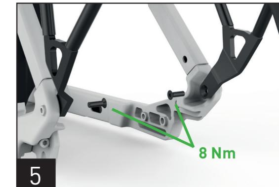
5. Verschrauben Sie anschließend die Ausfallenden des Trägers mit den SIC-Schnittstellen des Rahmens. Verwenden Sie dazu die mitgelieferten M5x12mm Senkkopfschrauben.
