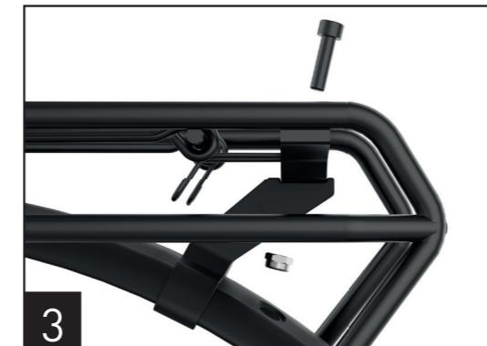
3. Verschrauben Sie den Schiebebrücken-Adapter mit dem hinteren Ende des Gepäckträgers. Verwenden Sie hierzu die mitgelieferte M6x25 Inbus-Schraube und M6 Mutter. Klicken Sie anschließend den Schiebebrücken-Adapter auf das Schutzblech. Achten Sie auf einen einwandfreien Formschluss zwischen Schiebebrücken-Adapter und Schutzblech!
