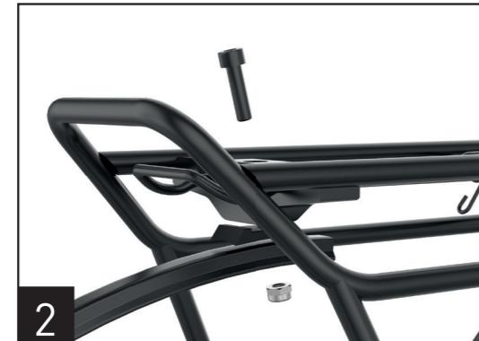
2. Verschrauben Sie den vorderen Montagepunkt des Gepäckträgers mit der Unterlaufstrebe am von Ihnen markierten Montagepunkt mit dem mitgelieferten Adapter (zwischen Träger und Unterlaufstrebe), der M6x20 Inbusschraube und M6 Mutter.
