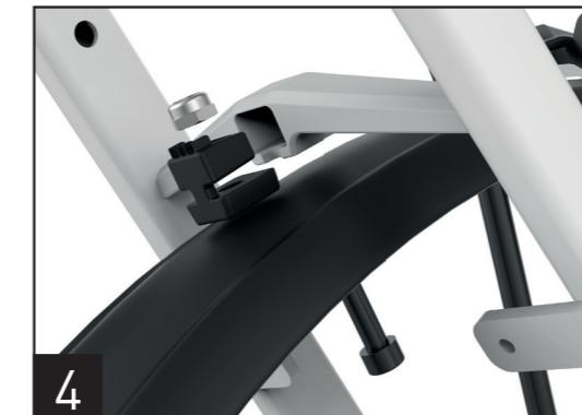
4. Verschrauben Sie die Gepäckträger- und Schutzblech-Einheit via dem mitgelieferten Einsatz-Adapters an der SIC-Sitzstrebengelenkbrücke des Rahmens. Verwenden Sie hierzu die M6x25mm und M6 Mutter. (mit zusätzlichen Distanzstücken M6x30)
