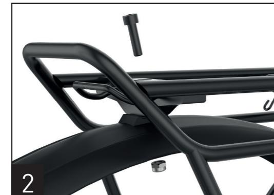
2. Verbinden Sie das vordere Ende des Gepäckträgers mit dem Schutzblech und der Unterlaufstrebe. Verwenden Sie hierzu den mitgelieferten Adapter (siehe Übersicht!), die Inbus-Schraube und M6 Mutter.
