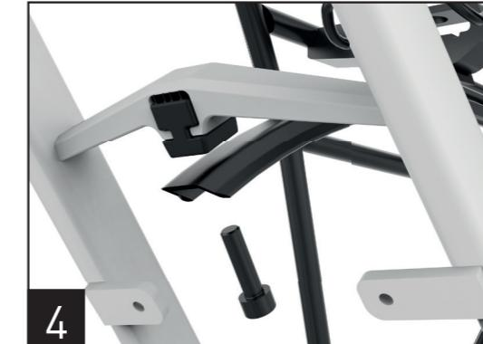
4. Setzen Sie die Träger-Einheit auf den Fahrradrahmen und verschrauben Sie das Langloch der Unterlaufstrebe mit der Sitzstrebengelenkbrücke des Rahmens. Schraube M6x25 oder falls mit zusätzlichen Distanzstücken M6x30.
