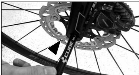
2. Fixe o eixo de libertação rápida à mão, com uma chave Allen.
