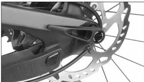
Pode agora puxar um pouco a alavanca do eixo e pode rodar a alavanca para qualquer posição. Para apertar ainda mais o eixo, pode empurrar a alavanca novamente para o eixo de uma forma cómoda e aplicar um torque renovado.
