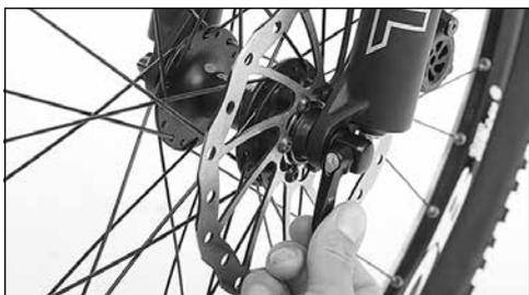
2. Rode a porca para a esquerda até a roda poder ser retirada do quadro ou do garfo frontal sem muito esforço.
