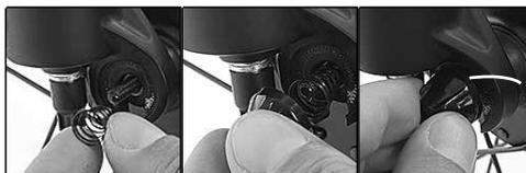
3. Ao apertar as alavancas de liberação rápida do espigão do selim: rode o próprio parafuso para a direita na tomada hexagonal em vez da porca.
