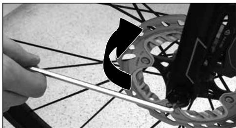
3. Em seguida, use uma chave de torque para aplicar o valor predefinido do fabricante, mas nunca mais do que 16 Nm.
