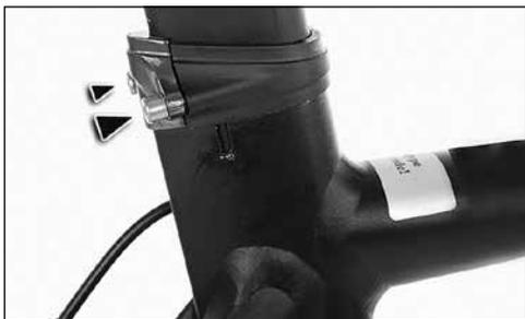
Para fixação sem eixo de libertação rápida, será necessária uma chave Allen e uma chave de torque no tamanho adequado. Consulte também o seu revendedor especializado sobre este assunto.
