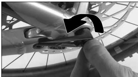
4. Quando tiver apertado suficientemente o eixo, mova a alavanca para uma posição avançada no sentido da marcha e empurre a alavanca para o eixo. Aperte agora novamente o parafuso de bloqueio em 180° para a direita, para fixar a alavanca contra a rotação por si mesma.
