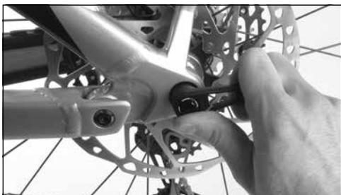
2. Utilizando a alavanca e uma força manual forte, ajuste o eixo bem apertado. Não deve ser excedido um torque comparável de 16 Nm.
