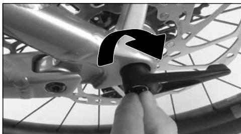
5. Para soltar o eixo, pode usar diretamente a alavanca e rodá-lo para a esquerda. Se não for possível aplicar força suficiente na posição de alavanca, então passe pelos passos 1 a 4 por ordem inversa. Isto permite-lhe mover a alavanca para uma posição que facilite a sua libertação.
