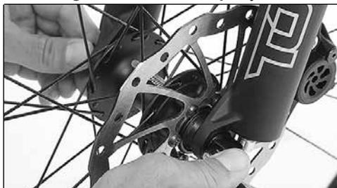
5. Agora, rode a porca de parafuso ou a tomada hexagonal até que a alavanca excêntrica apenas possa ser movida contra a resistência ao girar em torno do seu rolamento a partir de 90° (forma assim a extensão aproximada em linha reta do eixo do cubo).
