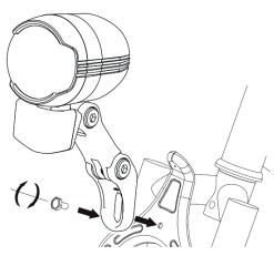
Positionieren und Befestigen Sie den Haltebügel (5) des Scheinwerfers (1) an der gewünschten Stelle am Fahrrad. Achten Sie darauf, dass der Scheinwerfer sich nicht von allein wieder verstellen kann (5Nm).
