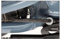
Bild: Chain wear gauge
