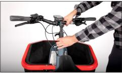
Bild: Adjusting the handlebar height
