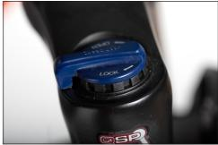
**Bild:** Suspension fork locked (=LOCK)
