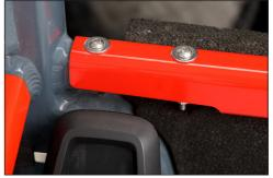
Bild: Front box screw connections
