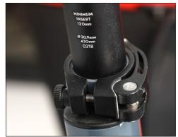
**Bild:** Marking for the minimum seat post insertion depth
