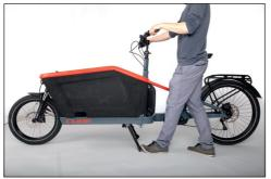
Bild: Folding out the kickstand
