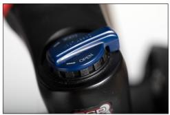
**Bild:** Suspension fork open (=OPEN)
