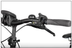
Bild: Brake lever on the handlebars
