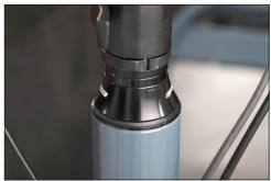
Bild: Head set on handlebars
