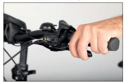
Bild: Brake lever fully applied
