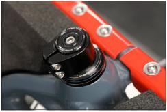
Bild: Head set on steerer tube clamp
